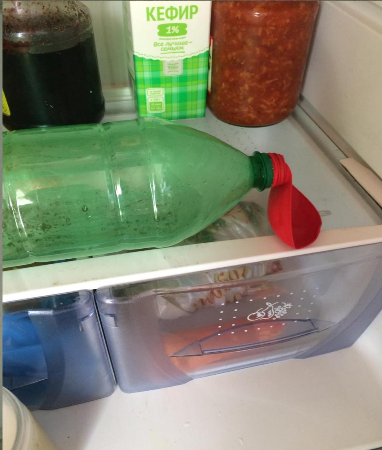
**Вывод:** при нагревании воздух расширяется и поступает в шарик, а при охлаждении сжимается и шарик сдувается.
